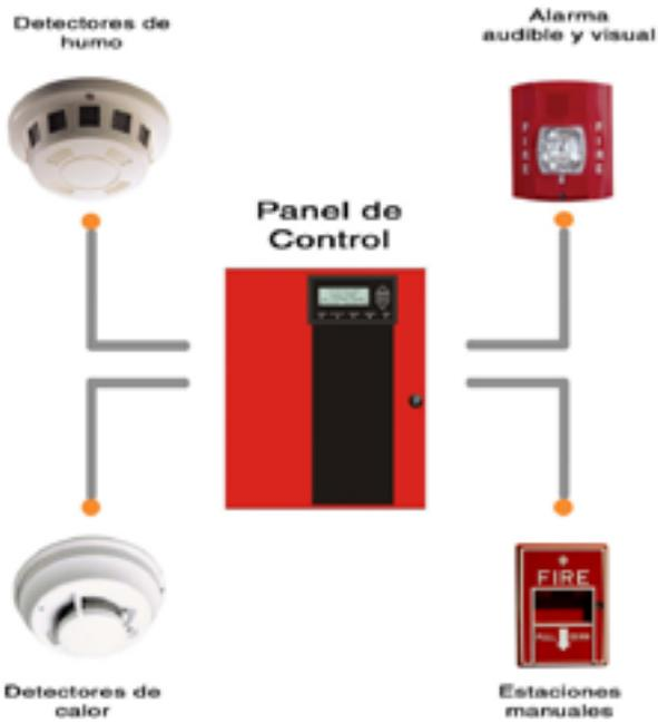
Las alarmas de humo son dispositivos que, al momento de detectar humo, son capaces de emitir directamente una alarma audible, no requiriendo de la conexión a un panel. Estos dispositivos pueden ser alimentados por corriente o bien ser autónomos por medio de baterías. Las alarmas de humo pueden reducir muertes por incendio hasta en un 90%.
